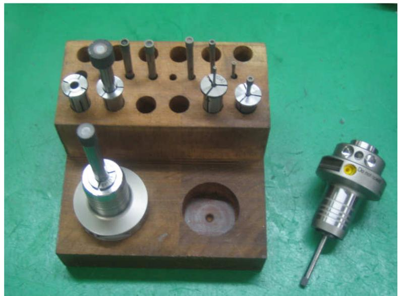
Hydro-Dehnspannfutter mit Reduzierstück und gespannten HM-Schleifstiften
